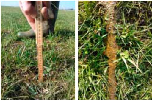
Test af nedfælderdybde ved dobbelt skærbredde (til venstre) samt resultat af nedfældning. Gyllen fylder strengen uden at løbe over. (Fotos: Annette V. Vestergaard, Videncentret for Landbrug).
